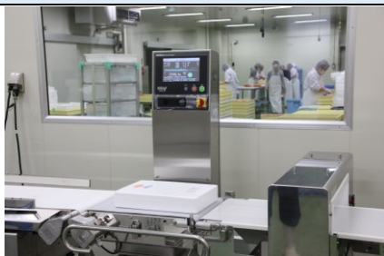
金探・ウェイトチェッカーで品質を管理しています。
