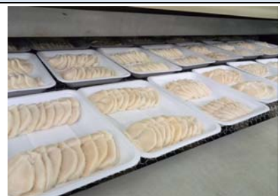
⑨トンネルフリーザー
